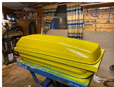
Her er den spesialbygde selvgående sonarfarkosten under konstruksjon i garasjen til Jan Arne Midtsæter. Foto: J.A. Midtsæter
