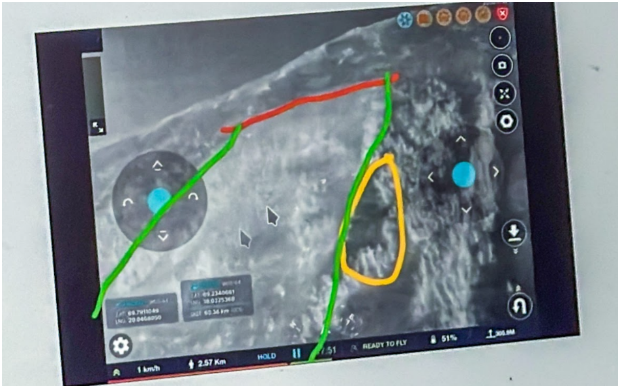
Utskrift fra droneopptak med inntegning av skred, kontrollert opp mot gps-punkter, digitale kart og funn av gjenstander. Foto: Norsk Folkehjelp
